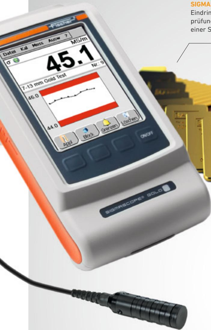
**SIGMASCOPE® GOLD B:** Hohe Eindringtiefe zur Echtheitsprüfung von Barren bis zu einer Stärke bis zu 17 mm.
