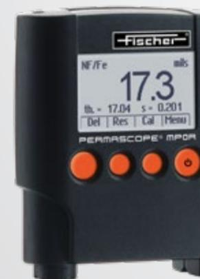
Messung von nicht magnetisierbaren Schichten auf magnetisierbaren Grundwerkstoffen
