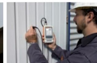
Messung einer Lackschicht auf Stahl
