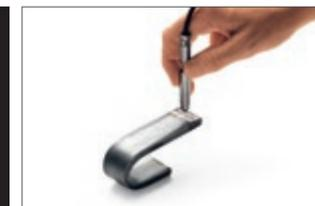
Ferritgehaltmessung im Schweißnahtbereich
