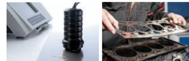
Handmesssonde mit Betastrahler
