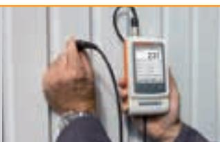
Lackschichtdickenmessung auf Stahl
