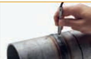
FERITSCOPE® FMP30: Ferritgehaltmessung an Schweißnähten
