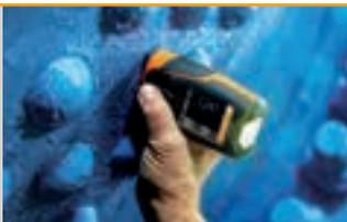
MMS® INSPECTION DFT: Messungen von dicken Schichten
