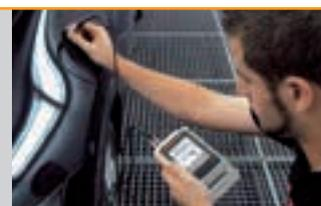
Lackschichtdickenmessung mit der Dual-Sonde FD13H
