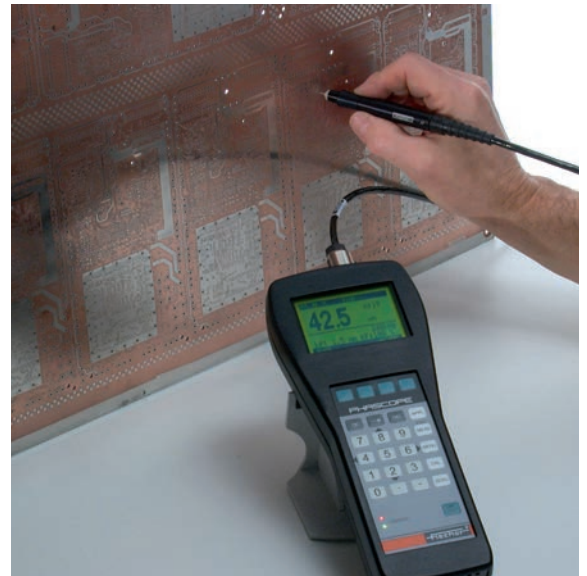
Messung der Aufkupperungsdicke in Bohrungen mit der Sonde ESL080B
