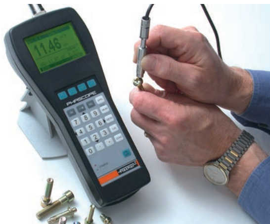
Die Sonde ESD2.4 eignet sich besonders gut für Kleinteile, da im Normalfall keine an die Messstellengeometrie angepasste Kalibrierung notwendig ist
