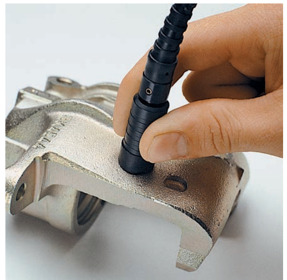
Messung auf rauen Oberflächen, Zn/Fe mit Sonde ESD20Zn
