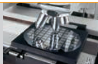
Wafer: Härtebestimmung an der Goldbeschichtung
