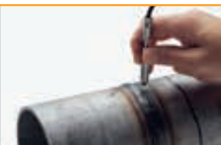
FERITSCOPE® FMP30: Ferritgehaltmessung an Schweißnähten
