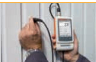
Lackschichtdickenmessung auf Stahl
