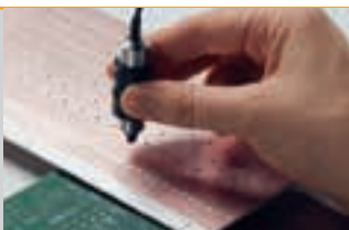
Messung der Kupferschichtdicke auf Leiterplatten
