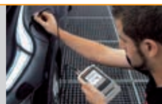
Lackschichtdickenmessung mit der Dual-Sonde FD13H
