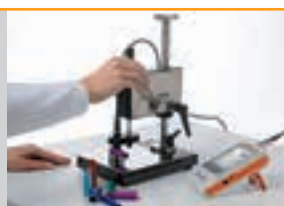
Messung mit Stativ auf gekrümmten Eloxalteilen
