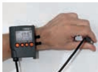
Handgelenkschalter für MPOR-FP Geräte zur Einhandbedienung
