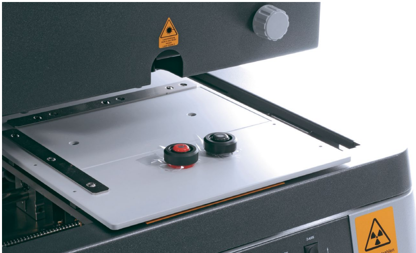
Die präparierten Lösungsanalyse-Zellen werden auf dem RFA-Gerät platziert und in Sekundenschnelle gemessen.
