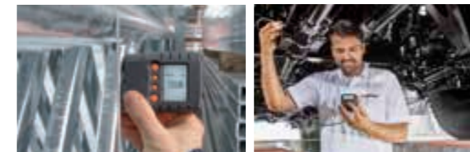
Messung von Eloxal auf Aluminiumrahmen für Gebäudeverkleidung
