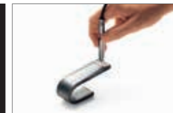
Ferritgehaltmessung im Schweißnahtbereich
