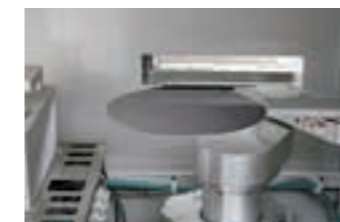
Handling-Roboter bestückt Messgerät mit Wafern
