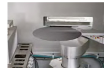
Handling-Roboter bestückt Messgerät mit Wafern
