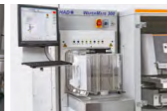
Automatisches Andocken und Laden von Wafern in standardisierten FOUPS und Cassettes
