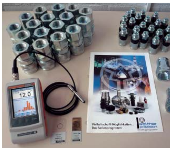
FMP 100 – Messplatz in der Qualitätssicherung
