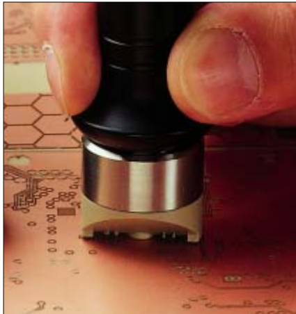
Messung der Kupferschicht auf einer Platine mit der Mikrowiderstands-Messsonde ERCU N.
