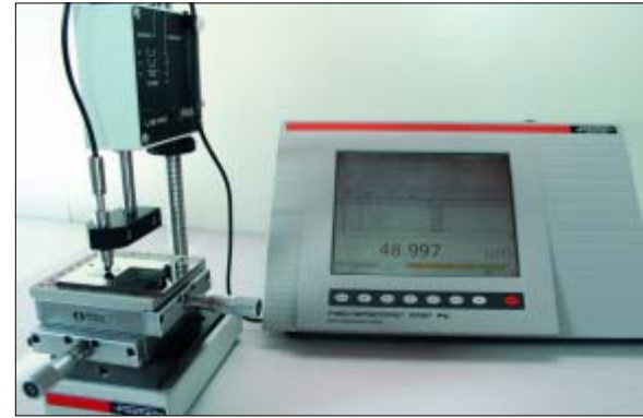
Bild1: Messaufbau für die Wiederholungsmessungen: Messgerät FISCHERSCOPE® MMS® PC mit der Sonde EGAB1.3, eingespannt im motorischen Stativ V12-AM.
