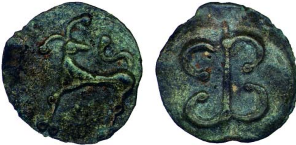
Gegossene Münze aus Altenburg. Auf der einen Seite ist ein Steinbock dargestellt und auf der anderen Seite vier Bronzeringe. Die ED-XRF Analyse zeigt, die Münzlegierung besteht aus einer komplexen Kupferlegierung: \text{Cu}_{55}\text{Sn}_{30}\text{Sb}_{9}\text{Pb}_{5}\text{As}_{1} .
