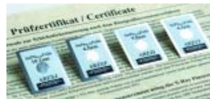
Abb. 3: Helmut Fischer bietet Sn-Folien Standards mit Zertifikat zur Kalibrierung der Messaufgabe Pb in Sn-Schichten an.
