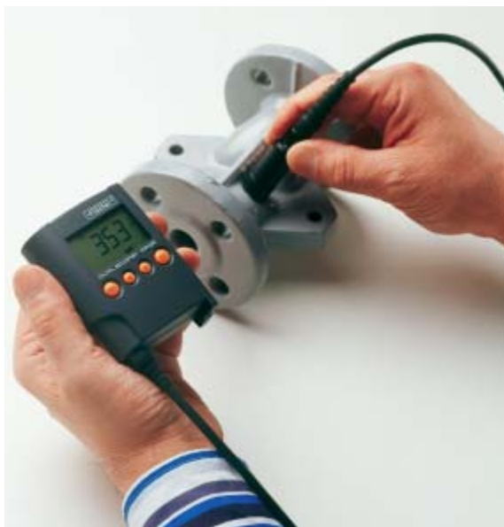
Teile mit komplexer Geometrie misst man idealerweise mit einem MPOR-FP
