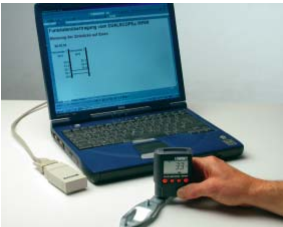
Unidirektionale Datenübertragung per Funk. Der dazu nötige Funkempfänger ist als Zubehör erhältlich
