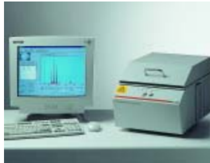
Röntgenspektrometer FISCHERSCOPE® X-RAY XAN® zur quantitativen Materialanalyse von Aluminium bis Uran.
