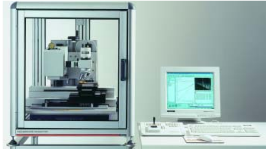
PICODENTOR® HM500, Gesamtaufbau eines Messplatzes mit PC, Keyboard und die Positioniervorrichtung mit programmierbarem Messtisch auf dem aktiven Schwingungsdämpfungstisch in der Messkammer.
