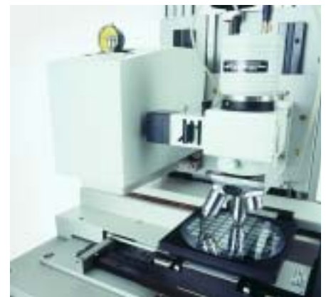
Beschichteter Wafer als Messgegenstand unter dem Videomikroskop zur genauen Bestimmung der Messposition(en).
