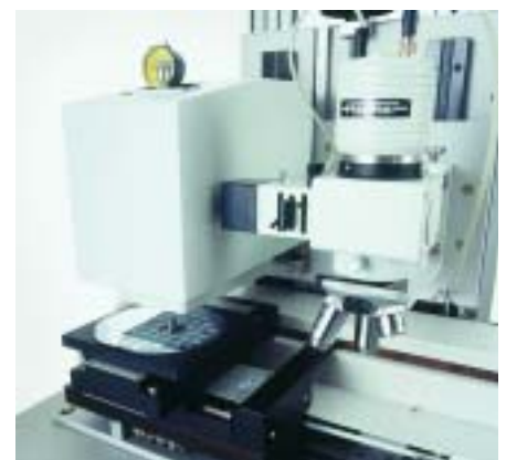
Zur Messung fährt der Messtisch automatisch unter den Messkopf, so dass die Härteeindrücke exakt an den gewählten Messpositionen erfolgen.
