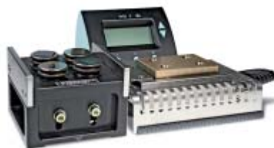
Abb. 3: Universalprobenhalter zur Fixierung dünner, kleiner Proben mit Hartwachs
