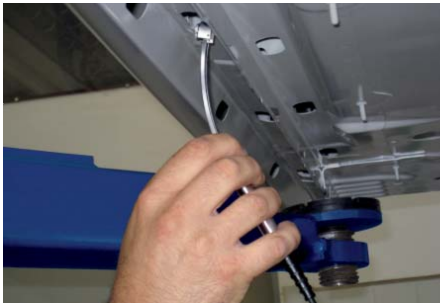
Bild 1: Sonde V3FGA06H, praktische Messung an einer Karosse (Werksphoto VW)
