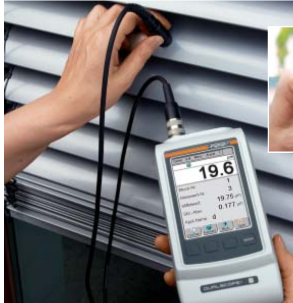
Bild 1: Messung der Lackdicke auf Jalousien mit der Sonde FTD3.3 unter Verwendung des Messgeräts DUALSCOPE® FMP100
