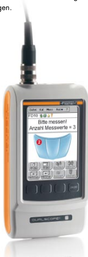
Bild 4: FMP100 mit Prüfplan. Messung an Messstelle (2) vorgeschlagen (3 Messwerte)
