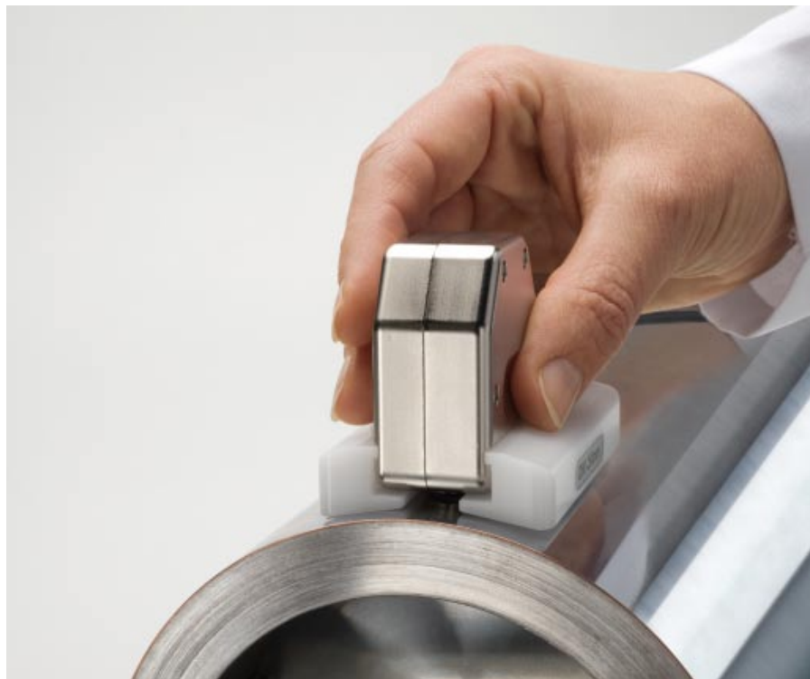
Bild 1: Sonde FN5D – praktische Messung auf einem Tiefdruckzylinder (Ø=140mm)
