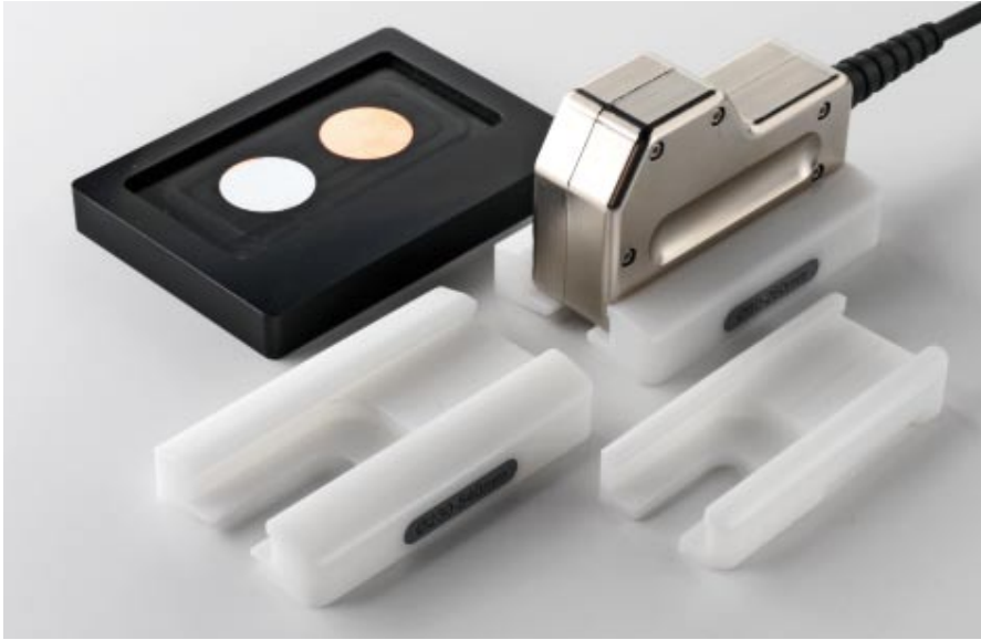
Bild 2: Sonde FN5D mit Zubehör – 2 Aufsetzprismen für Zylinder ( \varnothing_1=80\text{mm} bis 260\text{mm} ; \varnothing_2=230\text{mm} bis 540\text{mm} ); 1 Aufsetzprisma für ebene Teile; 1 Kalibrierstandard (Cr/Cu mit d_{Cr}=8\mu\text{m} , Cu- und Fe-Base)
