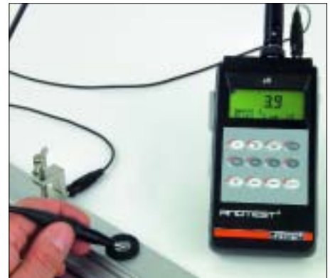
ANOTEST® YMP30-S mit Massekabel und Masseklemme, Messelektrode und Messzelle.
