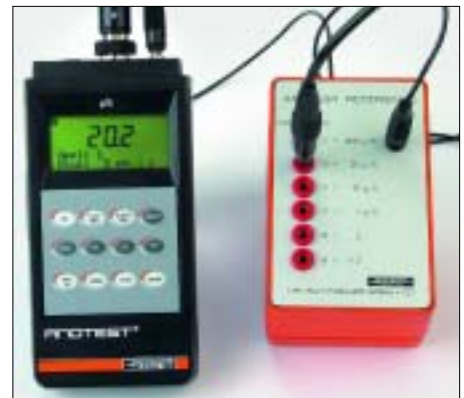
Genau elektrische Referenz zur Kalibrierung des ANOTEST® YMP30-S.
